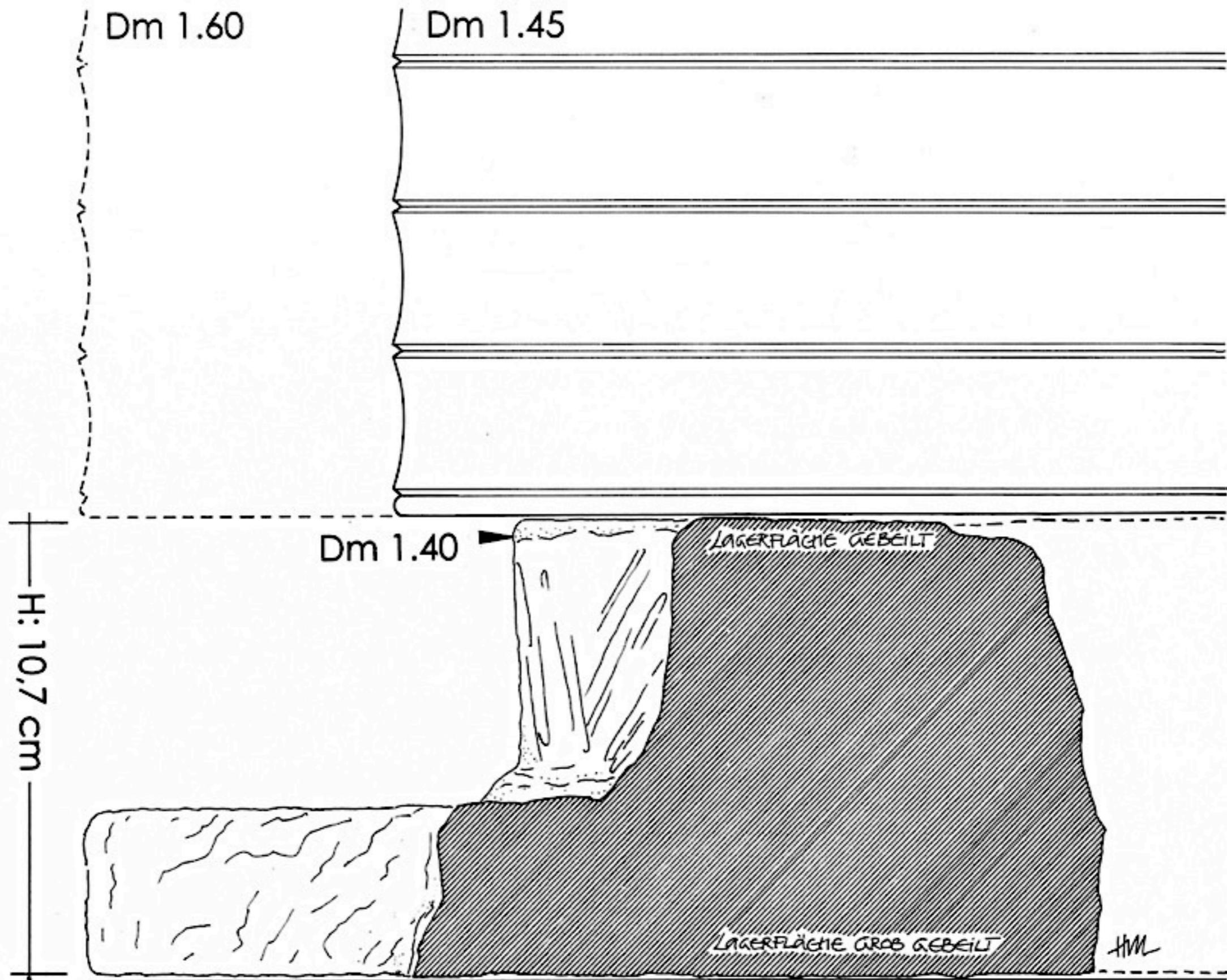
Abb. 18. Schnitt durch das Säulenstandsockelfragment mit aufliegender Spira; M. 1 : 2
